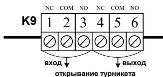
Пример 5. Подключение турникета (турникетный режим)
